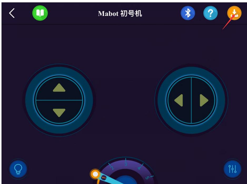
► 观察到左轮闪红灯和右轮闪绿灯，则将红色驱动球图标拖动到左边，绿色驱动球图标拖动到右边。然后点击【知道了】按钮下载程序到 Mabot 主控上。
